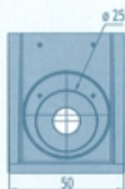
Bouche de drainage
